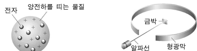
(가) 튜브 원자 모형: 양전하를 띠는 물질에 전자가 고르게 분포 (나) 러더퍼드 실험: 금박에 알파선을 쬐어 형광막을 관찰
